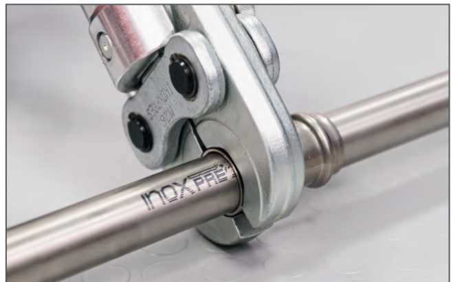
Assemblaggio attraverso pressatura / Making the press connection
