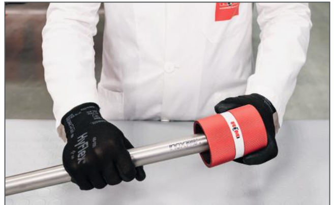
Sbavatura del tubo / Deburring the pipe
