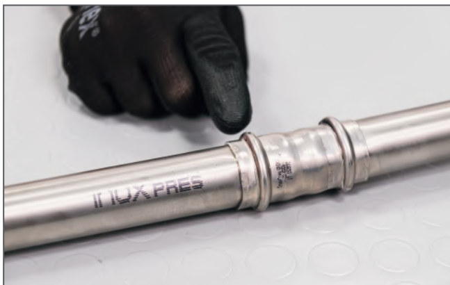
Controllo della pressatura / Checking the press connection
