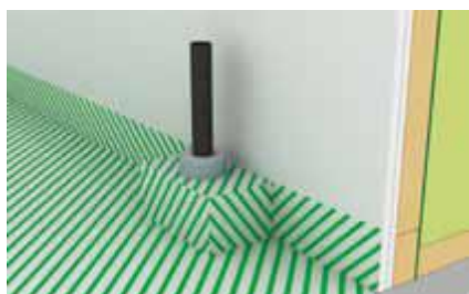
Figur 3 Rör genomföring våningsplan (Säker Vatteninstallation 2011:1 fig. 2.7.2 c)
